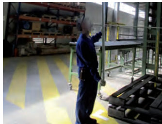
Figura 81 – Señalizar y no obstruir las vías de paso
