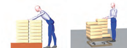
Figura 60 – Para evitar los alcances alejados en los palets, una solución puede ser colocar el palet en plataformas giratorias.
