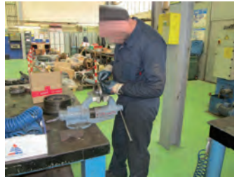
Figura 111 – Los bancos de trabajo regulables evitan realizar el trabajo en posturas forzadas de cuello
