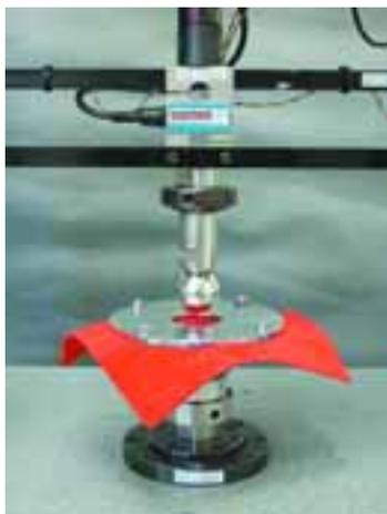
Figura 24. Ensayo de flexibilidad del corte.
