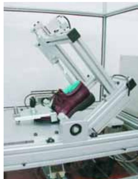
Figura 23. Máquina de ensayos LecFlex/IBV para el ensayo de flexión del calzado.
