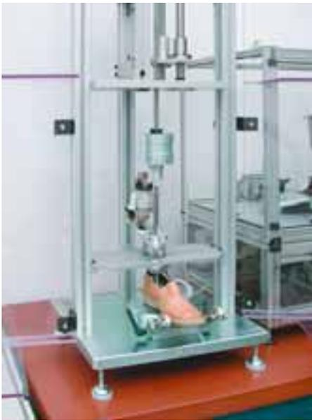
Figura 21. Máquina de ensayos LecCus/IBV para el estudio de la amortiguación frente a cargas de impacto.
