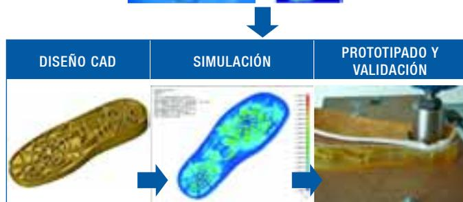
Figura 18. Integración de la información de las fuerzas actuantes sobre la suela durante la fabricación y su uso para la optimización del diseño mediante técnicas de simulación.
