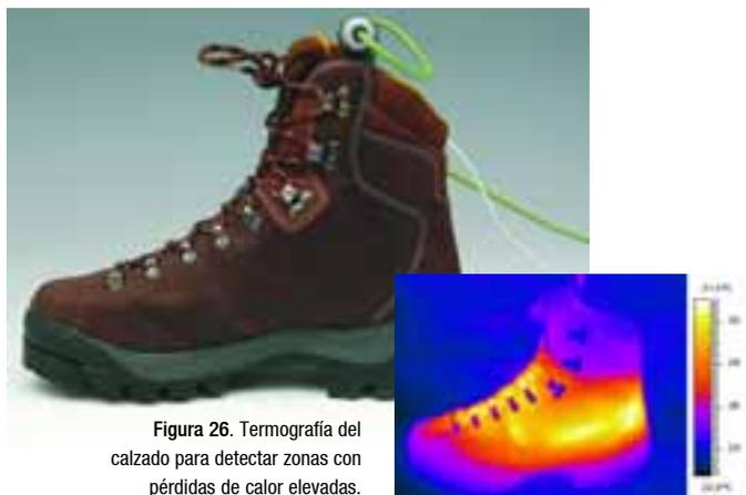
Figura 26. Termografía del calzado para detectar zonas con pérdidas de calor elevadas.
