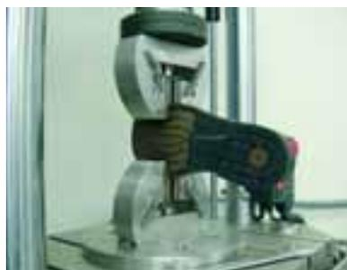
Figura 15. Arriba: Simulación por ordenador de los esfuerzos de expansión de la suela. Abajo: Ensayo con máquina para determinar las características mecánicas del sistema.
