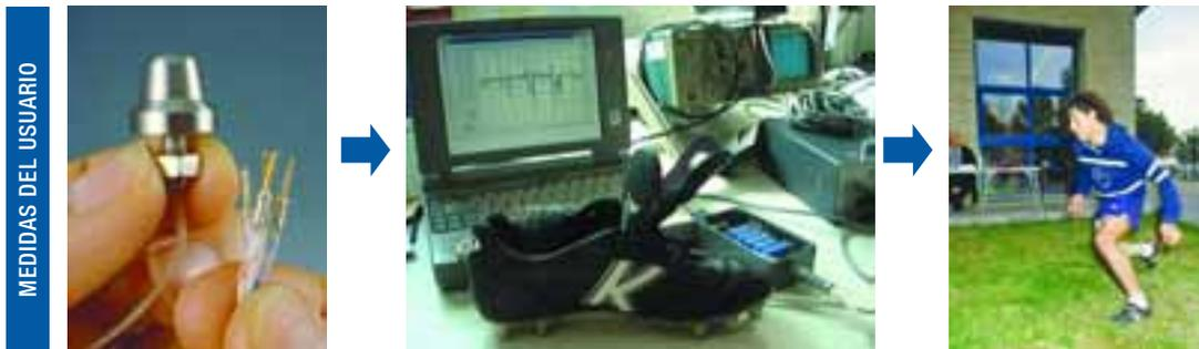
Figura 7. Bota instrumentada para medir fuerzas en los tacos individuales de botas de fútbol.
