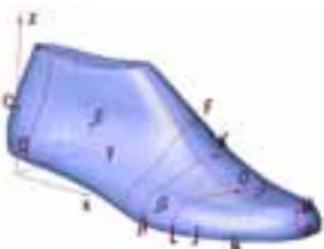
Figura 25. Horma 3D con diferentes secciones y medidas.
