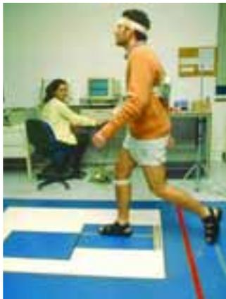
Figura 30. Ensayo de amortiguación de impactos, mediante técnicas de acelerometría y plataformas de fuerza.
