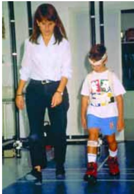
Figura 14. Ensayo de amortiguación de impactos y análisis de movimientos en calzado infantil.
