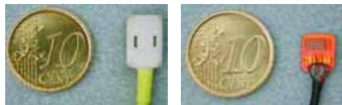
Figura 33. Izquierda: cápsula de medida del microclima (temperatura y humedad) en el pie. Derecha: sensor de medida de la temperatura superficial de la piel.
