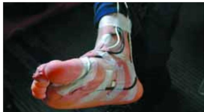
Figura 34. Pie instrumentado para los ensayos termofisiológicos (temperatura y humedad en el pie).
