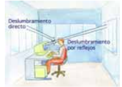
Figura 53 – Hay que evitar las ventanas situadas detrás o delante del trabajador, ya que provocan deslumbramientos y reflejos.
