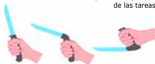
Figura 33 – El diseño del mango ha de conseguir una postura neutra de la muñeca cuando se realizan las tareas.
