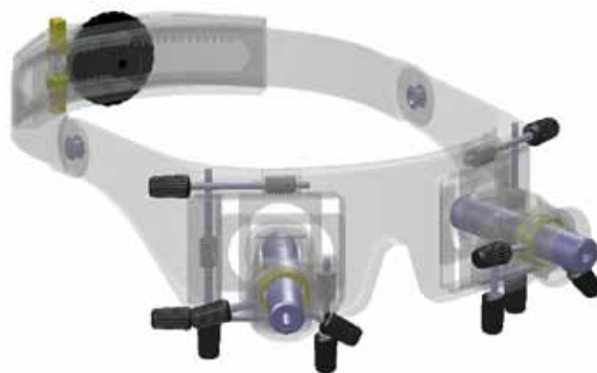
Figura 2. Modelo 3D del sistema de posicionamiento de los transductores de ultrasonidos diseñado por el IBV.
