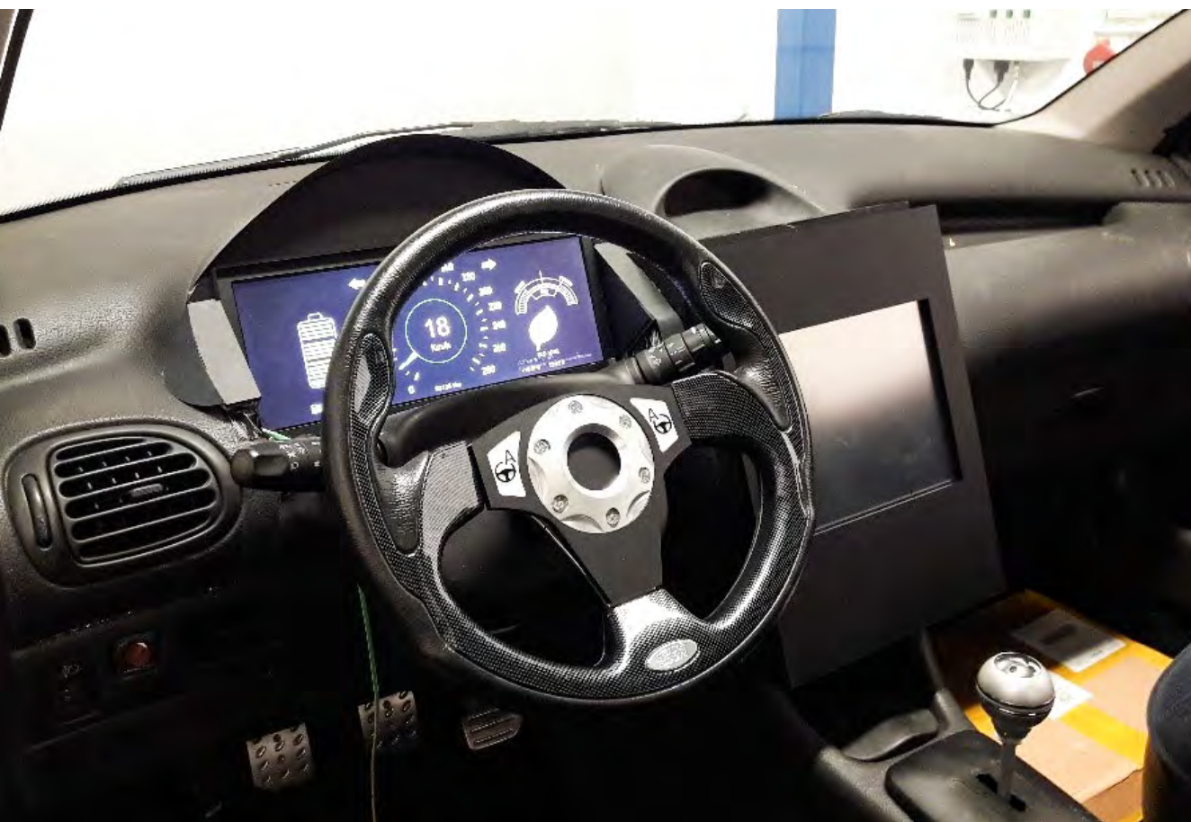
Figura 2. Simulador de conducción adaptado para la recreación de conducción autónoma.
