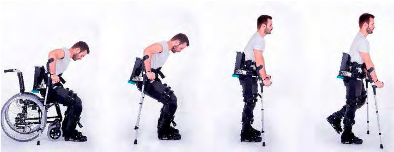
Recreación del modo de funcionamiento del robot 'Hank', de Gogoa Mobility Robots. INNOVADORES
