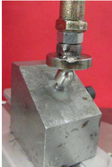
Figura 4. Ejemplo de montaje del ensayo dinámico de implantes dentales endoóseos (UNE-EN ISO 14801:2017).
