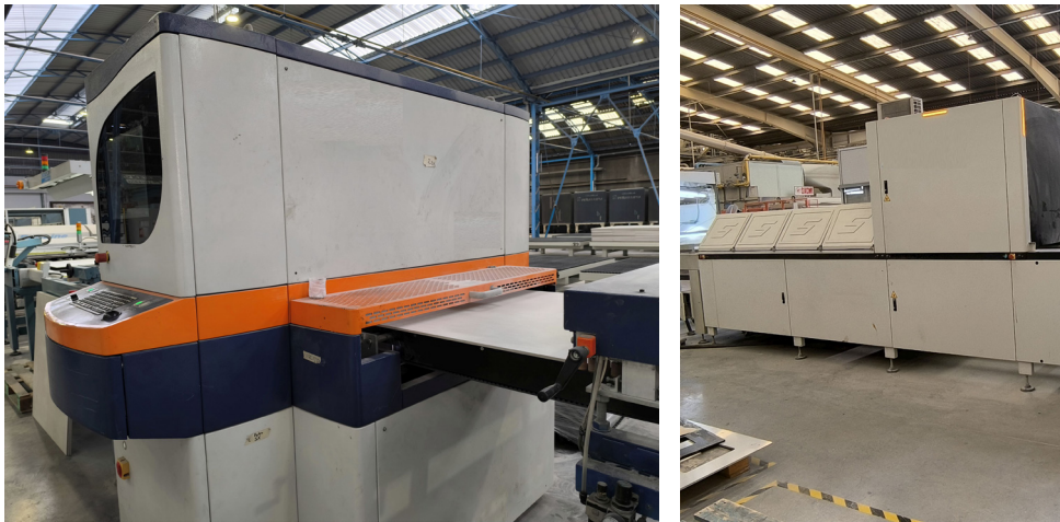
Figura 11. Altura fija de los controles y demasiado elevada (Fuente: estudio de campo).
