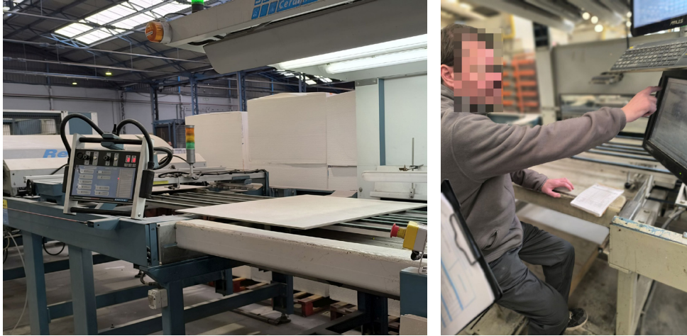
Figura 12. Ubicación de controles desalineada de la zona principal de trabajo (Fuente: estudio de campo).
