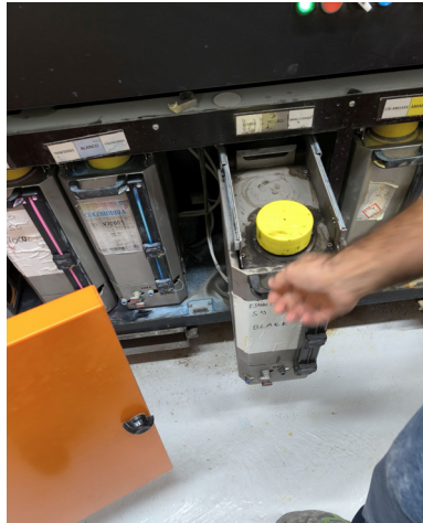
Figura 33. Depósitos de acceso individual y colocados sobre raíles / rodamientos (Fuente: estudio de campo).
