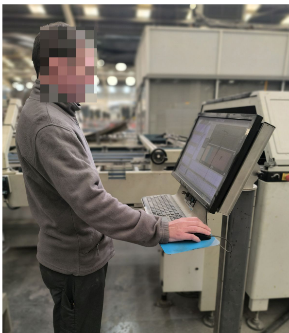
Figura 17. Plataforma para controles accesible y regulable en altura / inclinación (Fuente: estudio de campo).
