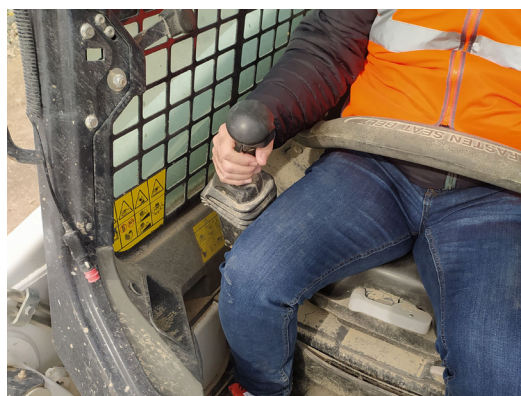
Figura 39. Apoyo de brazos en el arco de protección. Fuente: estudio de campo.
