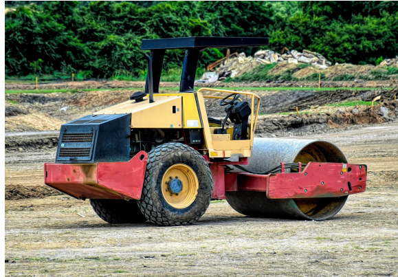
Figura 90 – Las cabinas no cerradas no permiten un aislamiento térmico ni acústico correcto
