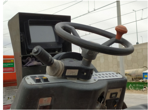
Figura 30. Protección de indicadores y displays para favorecer la visibilidad. Fuente: Estudio de campo.
