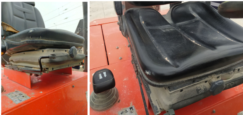
Figura 28. Sistema de ajuste al peso en el asiento del dumper. Fuente: Estudio de campo.
