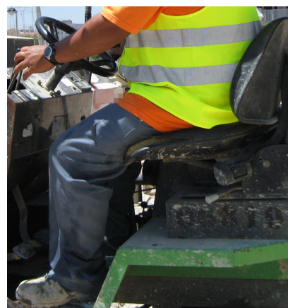
Figura 17. Espacio reducido en el puesto de conducción. Fuente: Estudios de campo IBV.
