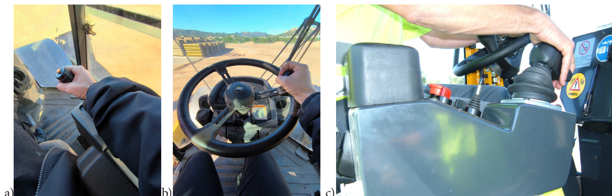
Figura 94 – Diseño ergonómico de controles para reducir los alcances y facilitar una postura neutra de los miembros superiores
