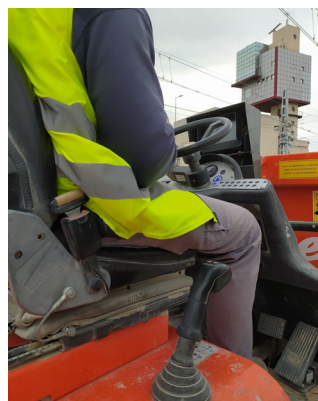
Figura 25. El diseño y las regulaciones en el dumper han de facilitar un espacio suficiente. Fuente: Estudio de campo.
