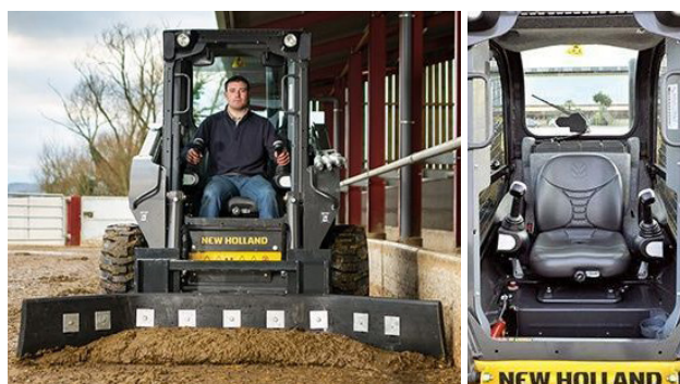
Figura 43. Diseño de la cabina para maximizar la visibilidad.
