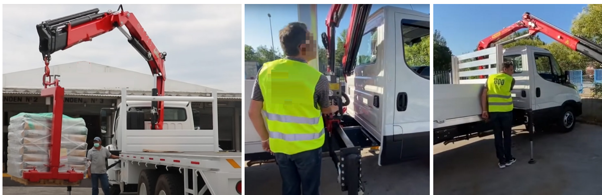
Figura 60 – Control de la grúa desde la estructura.
