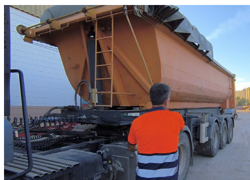
Figura 71 – Apertura de lona mediante palanca. Fuente: Estudio de campo.
