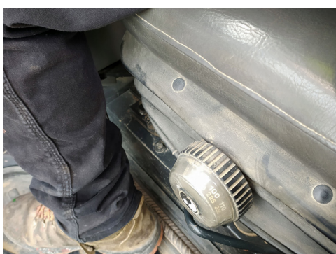
Figura 47. Sistema de suspensión y ajuste al peso en el asiento. Fuente: Estudio de campo.
