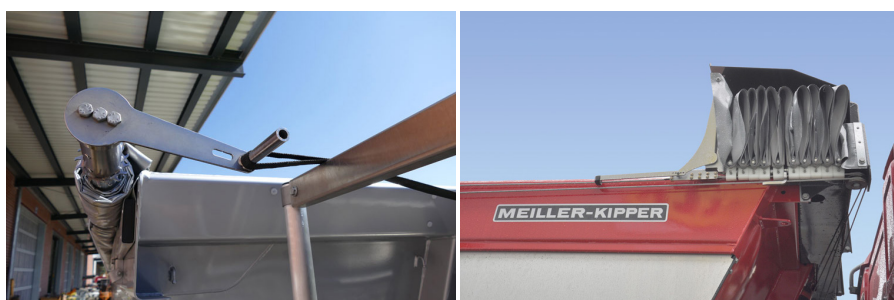
Figura 72 – Apertura de lona mediante palanca. Fuente: Meiller ( https://www.meiller.com/es/equipamiento-de-los-vehiculos/sistemas-de-lonas )
