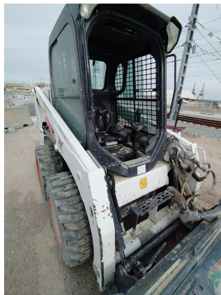
Figura 41. Modelos con cabina abierta o semi-abierta no permiten disponer de unas condiciones ambientales adecuadas (temperatura, ruido, polvo, etc.). Fuente: estudio de campo.
