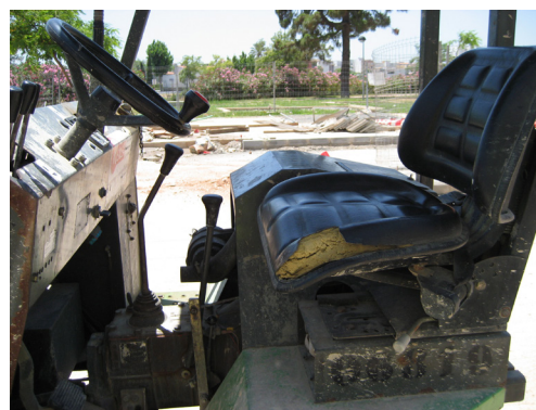
Figura 18. Diseño / mantenimiento inadecuado del asiento. Fuente: Estudios de campo IBV.
