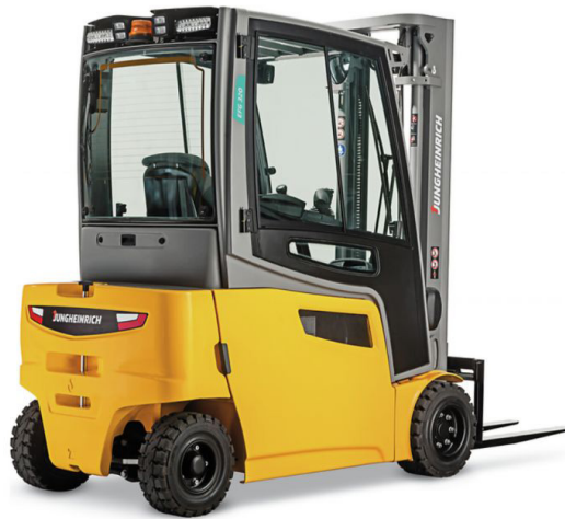
Figura 120 – Diseño cerrado de la cabina
