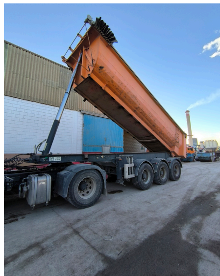
Figura 50. Camión bañera: basculación de la caja.
