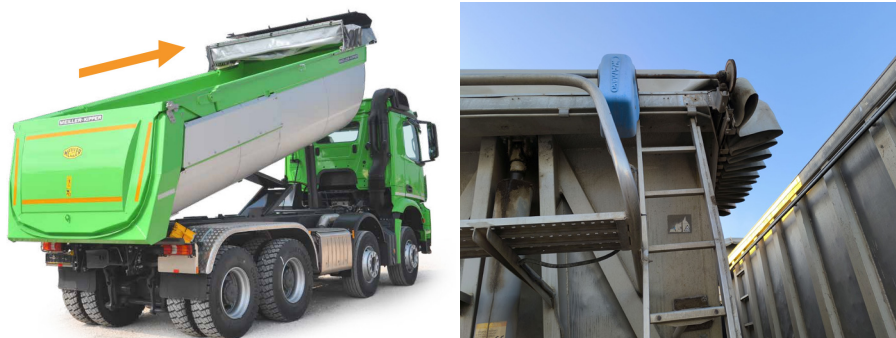
Figura 73 – Apertura de lona automatizada.
