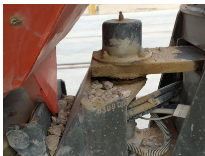
Figura 21 – Suciedad y falta de mantenimiento del Dumper. Fuente: Estudios de campo IBV.
