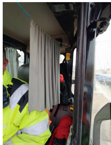
Figura 46. Protección de las cristalerías contra reflejos y deslumbramientos. Fuente: Estudio de campo.
