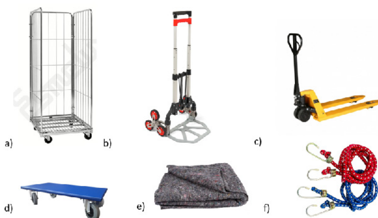
Figura 3.. Herramientas y medios mecánicos empleados en la tarea de transporte. a)Jaula Esmelux ( https://www.esmelux.com/ ) b) Carro HBM ( https://www.hbm-machines.com/es ) c) Transpaleta Manuleva ( https://www.manuleva.es/ ) d) y e) Plataforma con ruedas y manta kortpack ( https://www.kortpack.nl/es ) f) Ganchos elástico ( https://www.tredimark.es/es/ )
