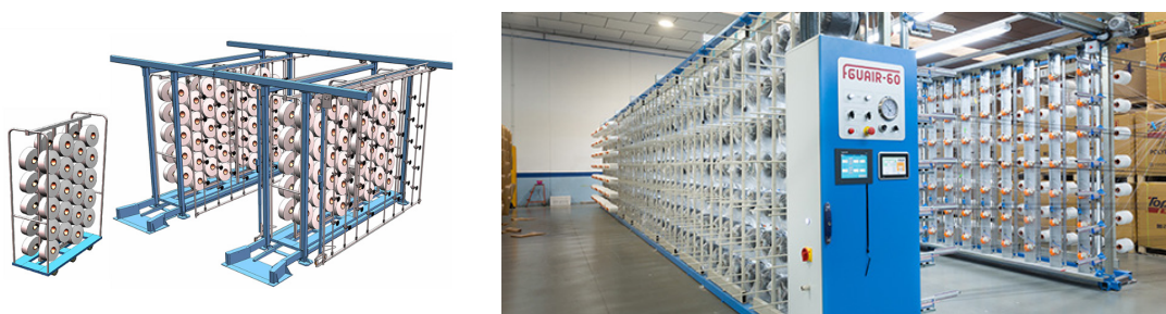
Figura 126. Fileta con carros alimentadores intercambiables (Fuente: Texma, COMSAT)
