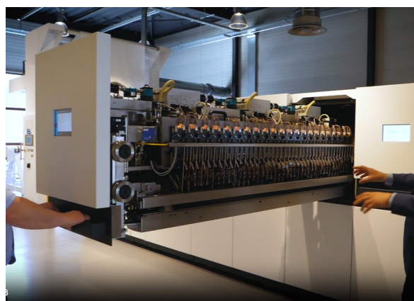
Figura 44. Sistema de extracción de cabezales de impresión (Fuente: SPGprints)
