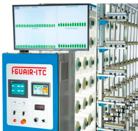
Figura 132. Sistema de información y control de tensión (Fuente: COMSAT)
