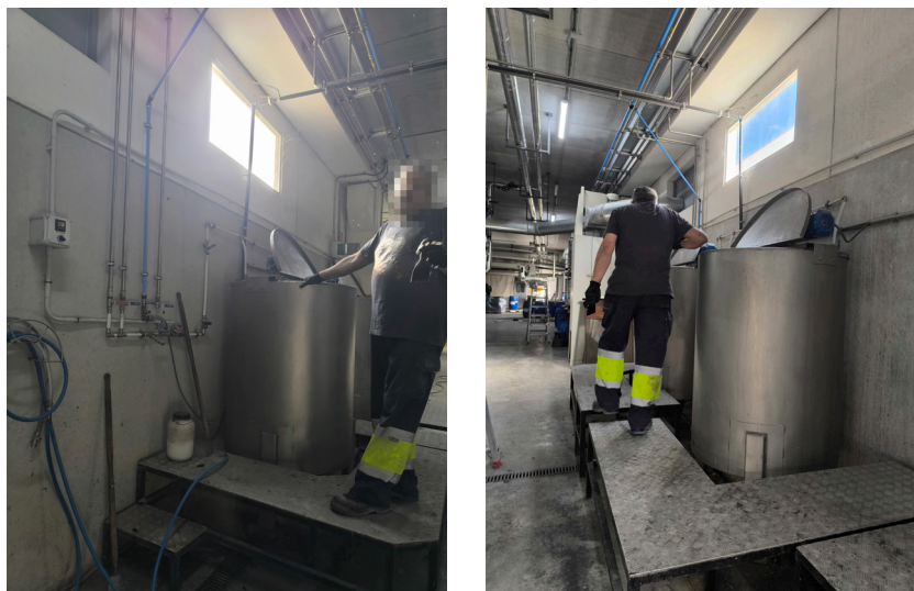
Figura 70. Plataformas rodeando las cubas de mezclas para facilitar la altura de acceso (Fuente: Estudio de campo).
