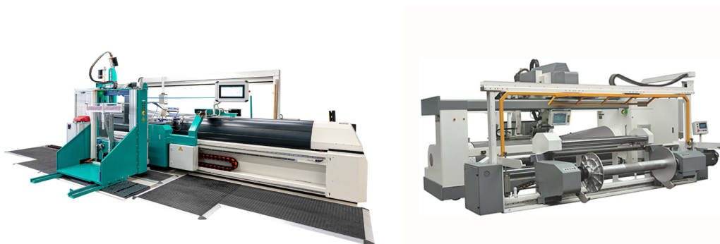
Figura 129. Máquina seccional automática (Fuentes: Karl Mayer, PRASHANT GROUP)
