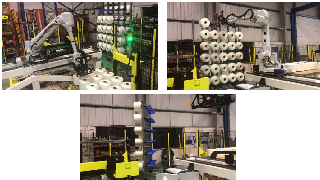
Figura 135. Sistema robótico de alimentación de bobinas (Fuente: Cygnet Texkimp)
