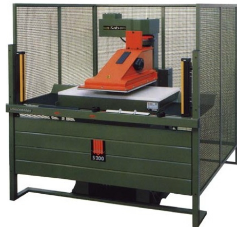
Figura 51. Troqueladora de brazo automática (Fuente: ATOM)).
