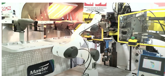
Figura 94. Alimentación y retirada con cobot (Fuente: Erps).
