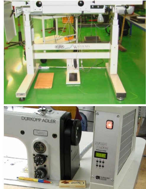
Figura 32. Mecanismo de ajuste de altura de la mesa de trabajo, y controles de ajuste (Fuente: INSST, 2021).
