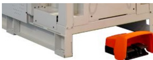
Figura 78. Máquina con espacio para los pies (Fuente: Avantium)
