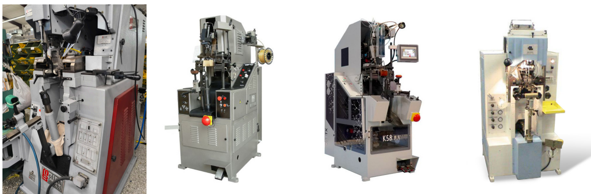
Figura 83. Diferentes modelos de máquinas de montaje de talones (Fuentes: Molina Bianchi, Avantium, Brustia Alfameccanica).
