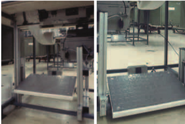
Figura 37. Pedal regulable en altura (Fuente: INSST, 2021).
