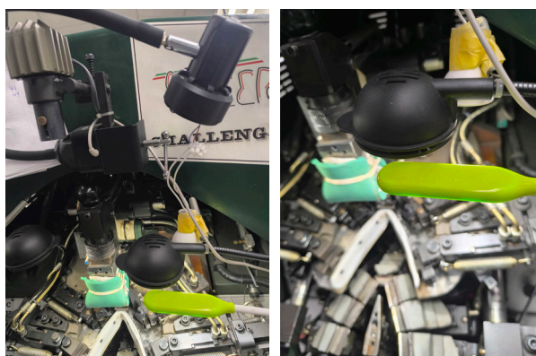
Figura 68. Iluminación localizada en la máquina (Fuente: Estudio de campo).
