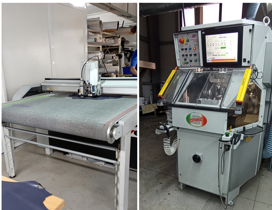
Figura 24. Máquinas de corte automática y máquina de cardado automático. Fuente: estudio de campo.
