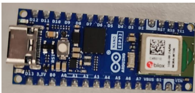
(Izq) Arduino ESP32 con BLE integrado. (Der) Acelerómetro triaxial
