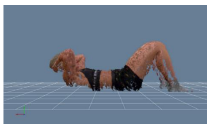
Visión lateral de un abdominal con el Move4D donde la malla está incompleta.
