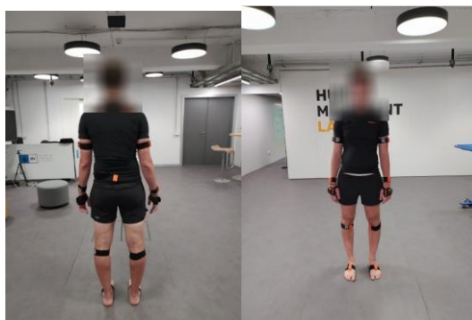
Vista frontal y trasera de un sujeto instrumentado con los 17 sensores inerciales correspondientes al modelo completo.
