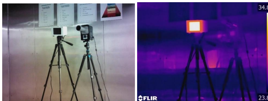
Cuerpo negro junto con cámara termográfica en la cámara climática.
