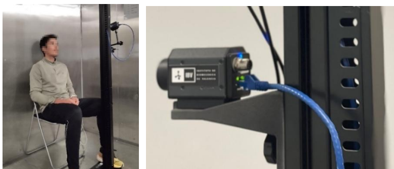
Imagen de un ensayo en cámara climática. Cámara FLIR A35.
