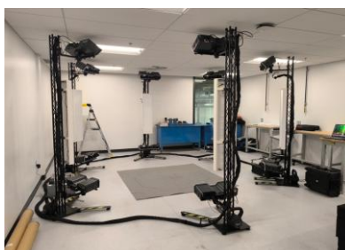
Montaje de la primera versión del escáner corporal 4D portable.
