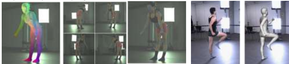
Figura 18. Izquierda: Exploración preliminar de inferencia 3D de marcadores en imagen. Derecha: Captura sincronizada de imagen y 3D para desarrollo de inferencias.
