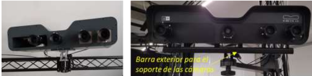
Figura 10. Izquierda: Diseño inicial del módulo. Derecha: Adaptación del diseño que incluye un soporte externo de anclaje de las cámaras para evitar desplazamientos debidos a la dilatación térmica.
