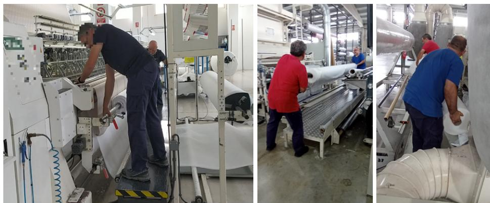
Figura 14. Manipulación manual de rollos (Fuente: estudio de campo).
