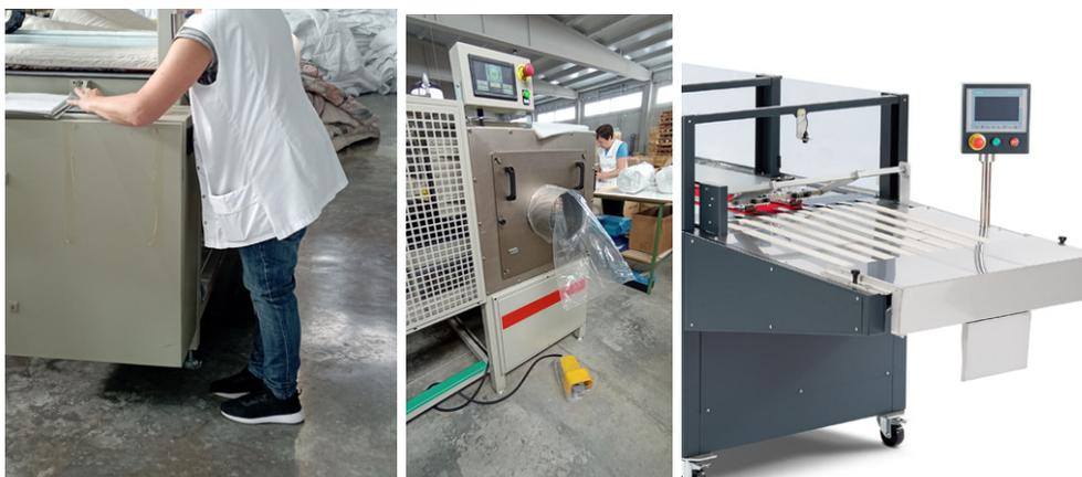
Figura 39. Ejemplos con distintas ubicaciones de mandos y pantallas de configuración (Fuente: estudio de campo, Thermotron).
