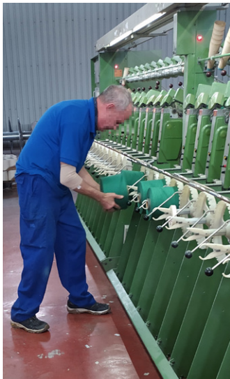
Colocación de bobinas. Fuente: estudio de campo (46) .
