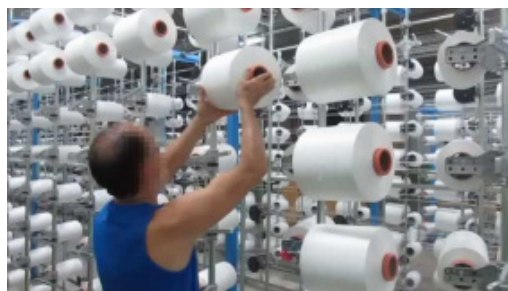
Colocación bobina altura elevada. Fuente: Web Textil IBV (13) .
