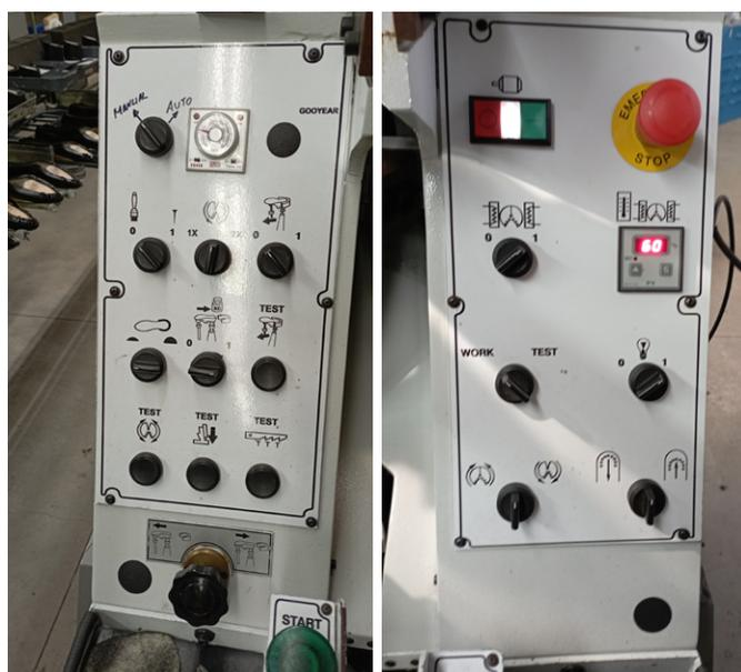
Figura 20. Pictogramas empleados en máquinas del sector. Fuente: estudio de campo.
