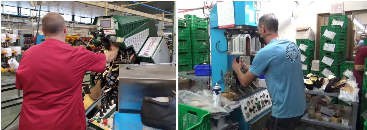
Figura 8. Abertura de acceso en máquinas del sector (Montado de enfranques y talones, y Moldeado contrafuertes). Fuente: estudio de campo.
