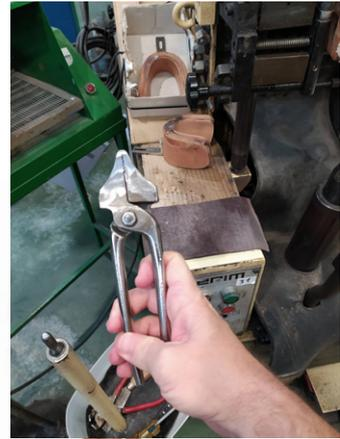
La **superficie del mango** debe ser antideslizante, sin ser tan lisa o pulida que pueda provocar deslizamientos no deseados, ni tan rugosa que cause incomodidad o abrasión.
