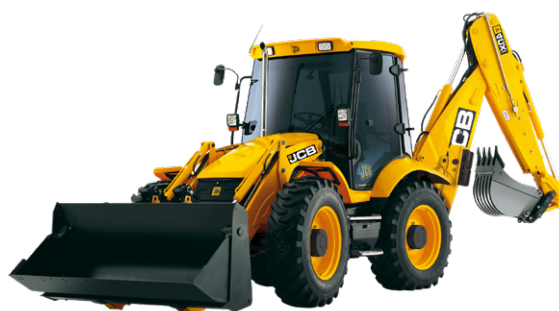
Figura 6. Retroexcavadora mixta. Fuente: Pixabay.
