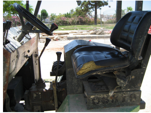
Figura 18. Diseño / mantenimiento inadecuado del asiento. Fuente: Estudios de campo IBV.
