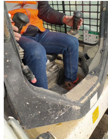
Figura 37. Espacio reducido en la cabina. Fuente: estudio de campo.
