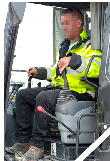
Figura 40. Posturas forzadas de la muñeca en el uso de las palancas. Fuente: estudio de campo.
