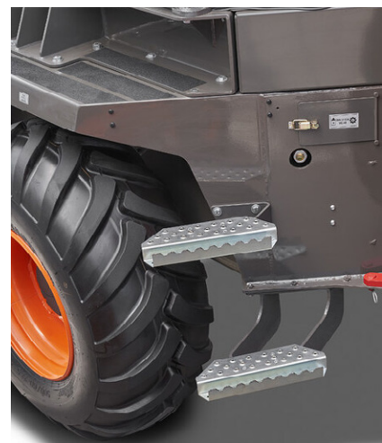
Figura 22. Acceso al dumper con escalones. Fuente: Ausa ( https://www.ausa.com/es-es/dumpers/dr1001ahg ).
