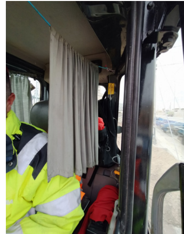
Figura 46. Protección de las cristaleras contra reflejos y deslumbramientos. Fuente: Estudio de campo.
