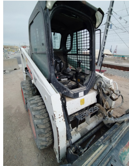
Figura 41. Modelos con cabina abierta o semi-abierta no permiten disponer de unas condiciones ambientales adecuadas (temperatura, ruido, polvo, etc.). Fuente: estudio de campo.
