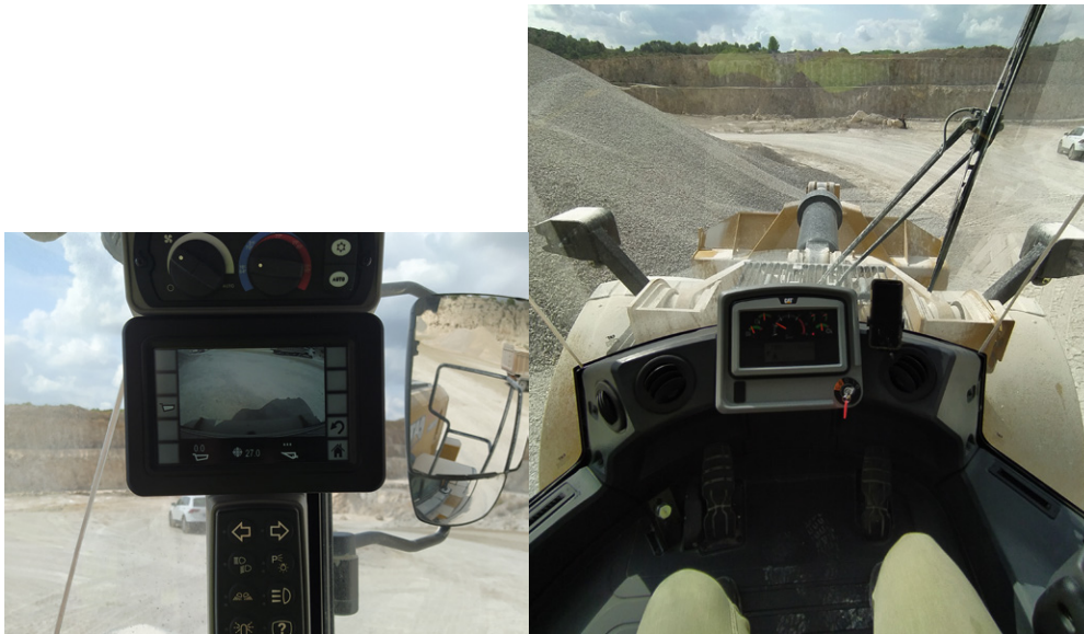
Figura 13. Elementos para facilitar la visibilidad. Fuente: estudio de campo.
