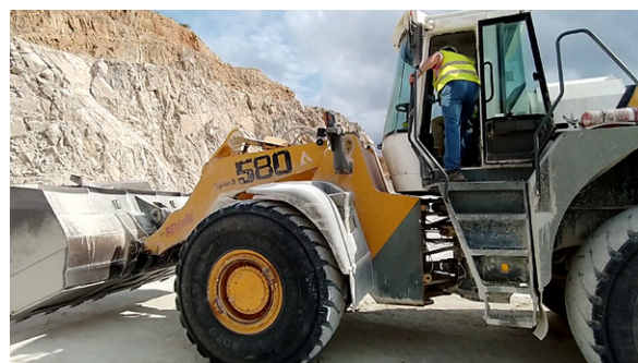
Figura 11. Acceso a la cabina.
