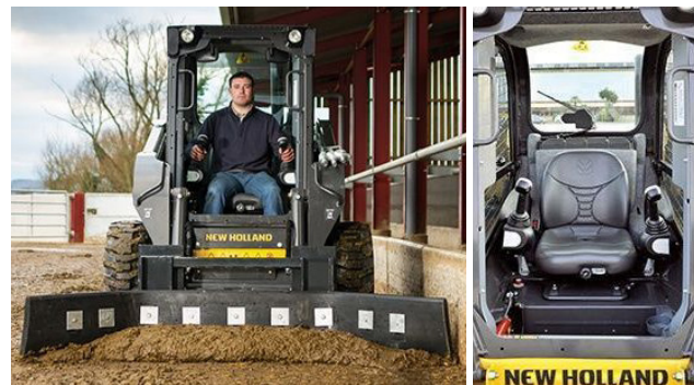
Figura 43. Diseño de la cabina para maximizar la visibilidad. Fuente: Esmac ( https://esmacsl.es/minicargadora/ ).
