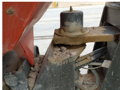
Figura 21 – Suciedad y falta de mantenimiento del Dumper. Fuente: Estudios de campo IBV.
