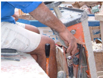
Figura 20. Diseño no ergonómico de los controles del Dumper. Fuente: Estudios de campo IBV.
