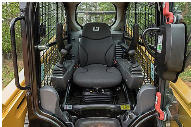
Figura 48 – Sistema de asiento ergonómico. Fuente: CAT ( https://www.cat.com/es_ES/products/new/equipment/skid-steer-and-compact-track-loaders.html ).
