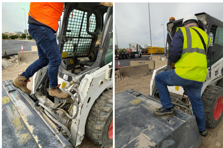
Figura 36. Acceso complicado a minicargadora con entrada frontal. Fuente: estudio de campo.
