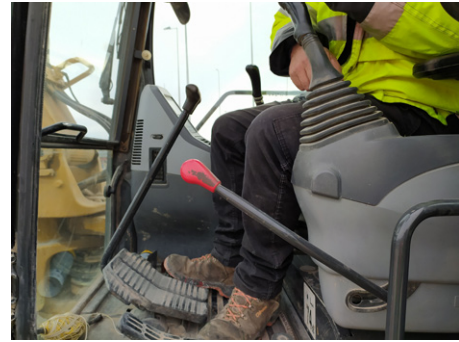
Figura 42. Asegurar el alcance cómodo a todos los elementos. Fuente: Estudio de campo.
